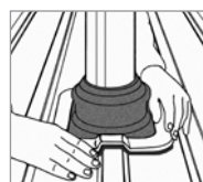
4. Ajustați Dektite® la forma plăcii profilate sau marcaj.
