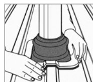
3. Ajustați Dektite® la forma plăcii profilate sau marcaj.
