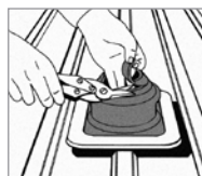
1. Ajustați Dektite® pe conductă.
