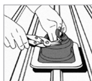
1. Ajustați Dektite® pe conductă.
