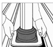
2. Ajustați Dektite® la placă profilată sau marcaj.
