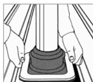
2. Ajustați Dektite® la placă profilată sau marcaj.
